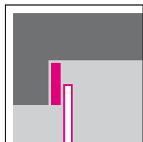
Faux-linteau entièrement monté derrière le linteau béton.
