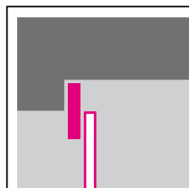
Faux-linteau en partie visible dans la baie (jusqu'à 100 mm).
