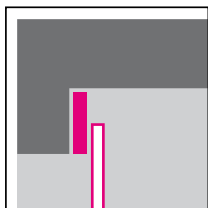
Maskownica montowana w całości za nadprożem.
