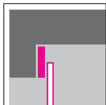
Lateipaneel compleet achter de latei gemonteerd.
