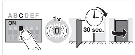
Wenn der DIL-Schalter C3 auf **OFF** steht (Werkseinstellung), dann ist die Aufhaltezeit deaktiviert und die Tür bleibt nach dem Öffnen in der geöffneten Position stehen. Die Tür lässt sich nur durch eine manuelle Türbewegung oder einen Fahrbefehl (Impuls) wieder schließen.
