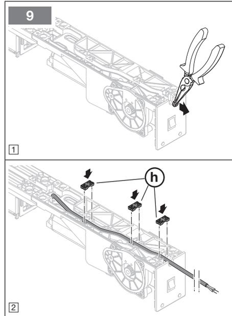
Die Kabelverlegung unter dem Antrieb ist nach rechts und nach links möglich.
