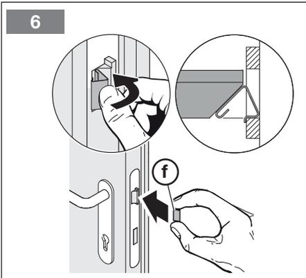
Setzen Sie die Schlossfalle mit der Fallenklammer außer Betrieb.
